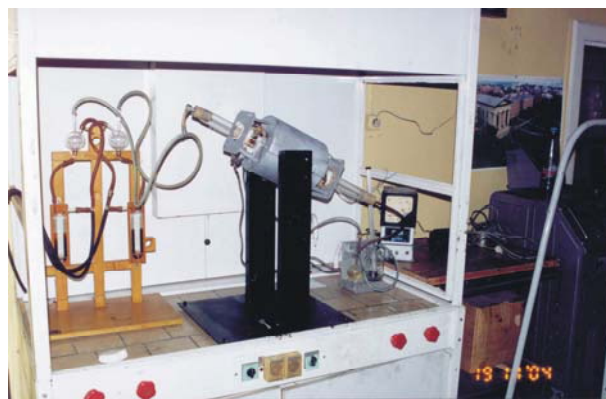
Рис. 1. Установка пиролизического синтеза с переменным углом наклона реактора.
