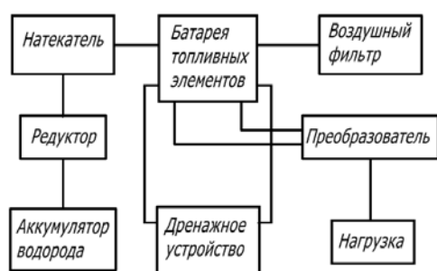
Рис. 2. Блок-схема аварийного водородного источника электроэнергии.
